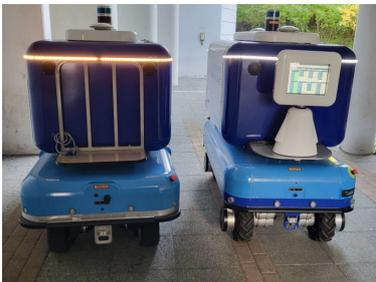
La plateforme a été conçue conjointement par l'IRIMAS et les acteurs industriels, Kompaï Robotics et Shark Robotics. Le but est de doter le campus Illberg de l'UHA de robots mobiles autonomes circulant en toute liberté sur le campus. La mission des robots est de livrer des colis et des lettres aux différents bâtiments le long du campus. De plus, la forme et l'aspect des robots ont été réalisés afin que l'un des robots puisse avoir une image anthropomorphique.
